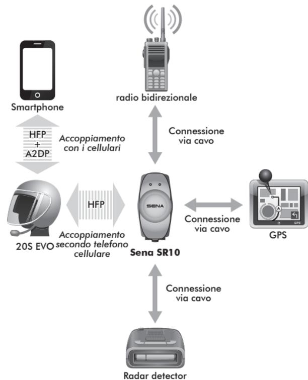
**Connessione parallela di SR10 e un cellulare tramite l'accoppiamento del secondo telefono cellulare Bluetooth**
