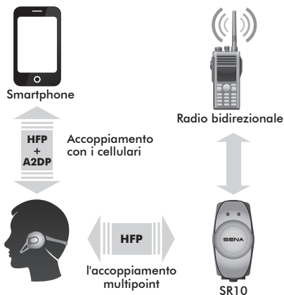
Connessione parallela di SR10 e un cellulare tramite l'accoppiamento multipoint Bluetooth
